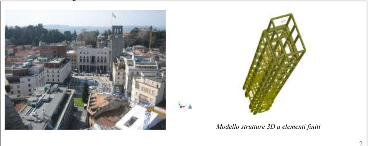
*Modello strutture 3D a elementi finiti*
